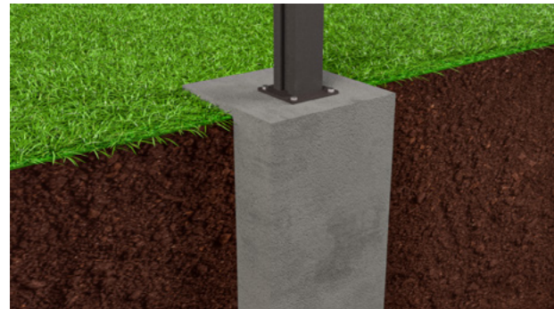
Montage mit Fußplatte auf Fundament
