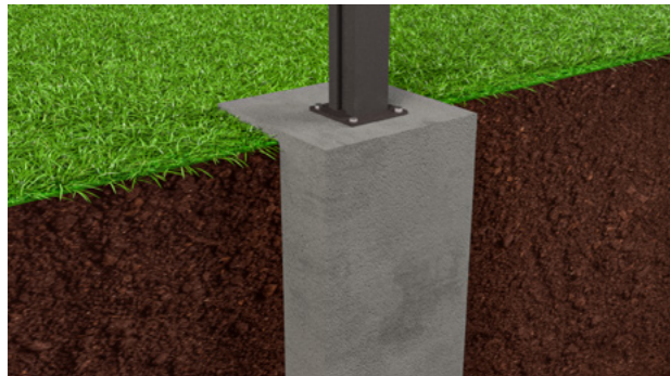
Montage mit Fußplatte auf Fundament
