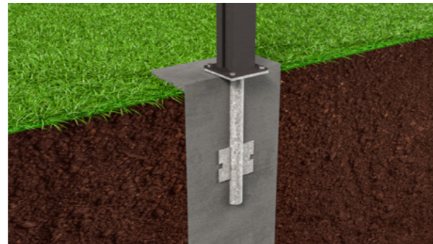
Montage mit Fußplatte auf Erdanker
