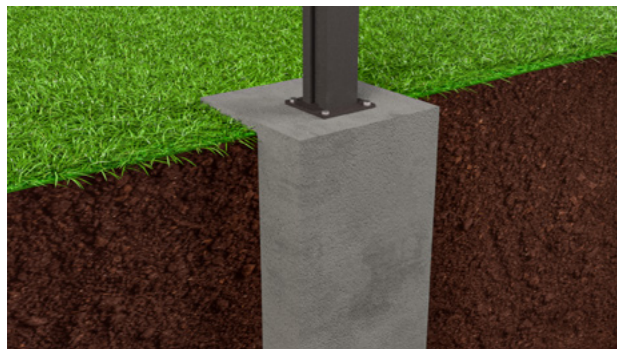
Montage mit Fußplatte auf Fundament
