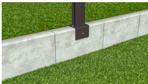
Montage mit L-Stein Fußplatte auf Mauer
